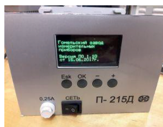
Опытный образец преобразователя промышленного двухканального П-215Д
