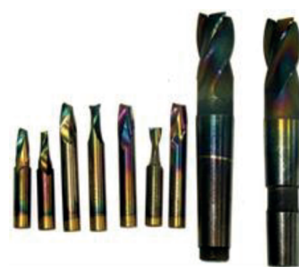
3 – образцы металлообрабатывающего инструмента с износостойкими покрытиями на основе углерода
