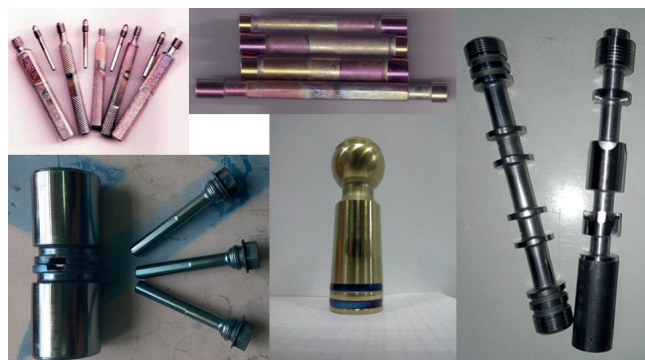
Рисунок 2 – Детали прецизионных пар трения и инструмент с модифицирующими покрытиями
