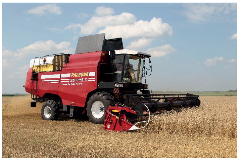
Самоходный зерноуборочный комбайн КЗС-4118К, работающий на сжатом природном газе
