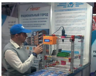
Фотополимерный LCD 3D-принтер на базе МФУ MultiCube-1
