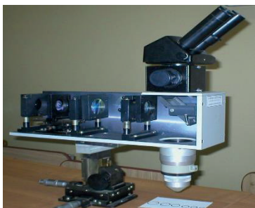
4 – оптическая приставка для формирования пучков кольцевого сечения
