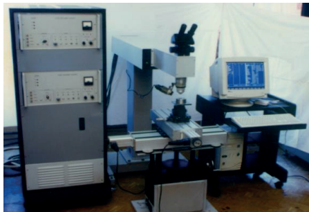
1 – оборудование для обработки материалов лазерными пучками специальной геометрии
