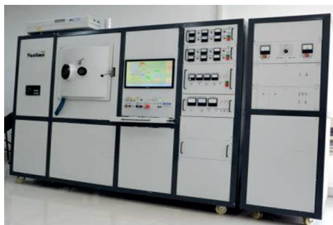
1 – вакуумное оборудование для формирования покрытий различного функционального назначения
